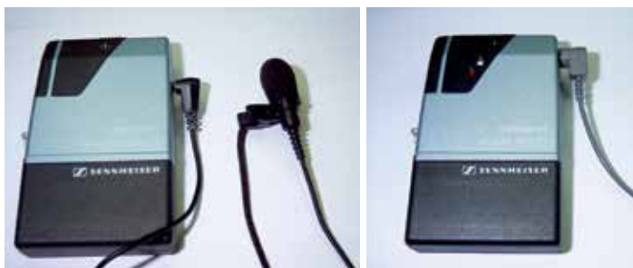
Abbildung 1: Sennheiser Mikroport-Anlage 2013 (links: Sender, rechts: Empfänger)
